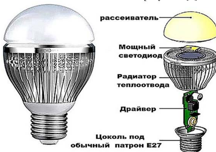
Рисунок 1 – Общая конструкция светодиодных ламп
