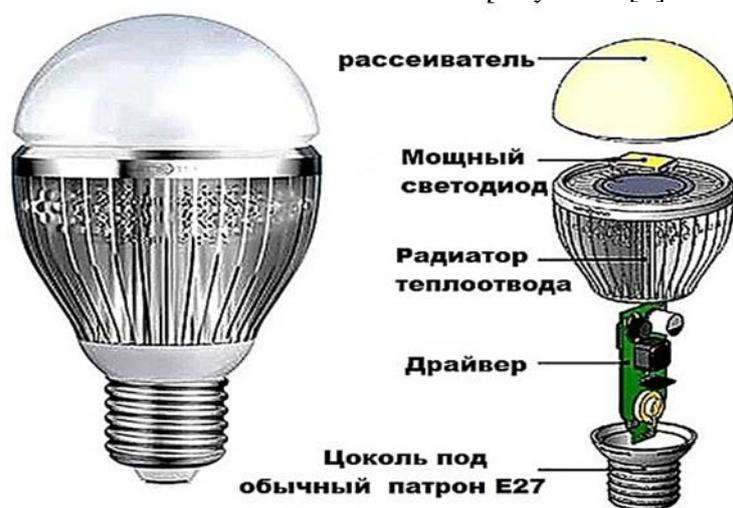
Рисунок 1 – Общая конструкция светодиодных ламп
