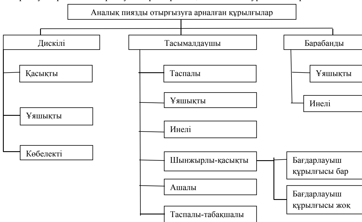
1-сурет. Аналық пиязды отырғызуға арналған отырғызу аппараттарының жіктемесі
