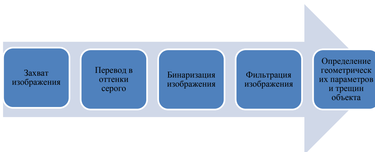
Рисунок 1 – Алгоритм работы программы обнаружения трещин
