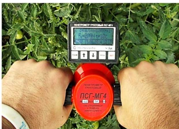
Рисунок . 3 Твердомер и электронный блок в работе
