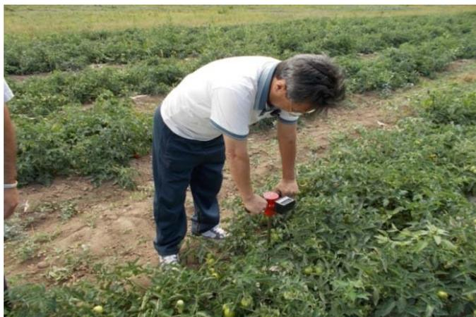
Рисунок. 4 Пенетромтр в состоянии проверки почвы
