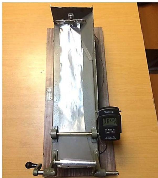
Рисунок 3 – Схема и общий вид испытательного прибор на растяжение 1 – рукоятка; 2 - опора, 3 – мерная шкала, 3- подвижная часть, 4- образец растяжения; 5 - тензодатчик
