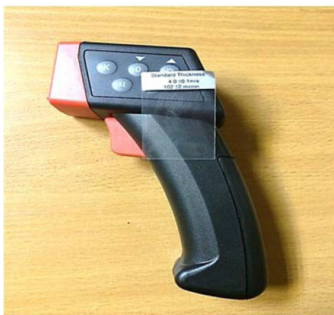
Рисунок 1 – Прибор для замера толщины пленки с калибровочной пленкой
