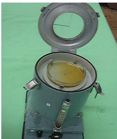
Рисунок 1. Рабочий вид прибора Кротова для определения микробной обсемененности воздуха
