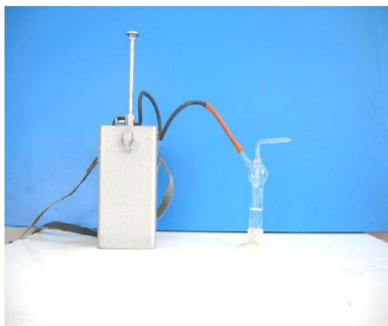
Рисунок 2. Рабочий вид устройства Улавливателя микроорганизмов для определения микробной обсемененности воздуха
