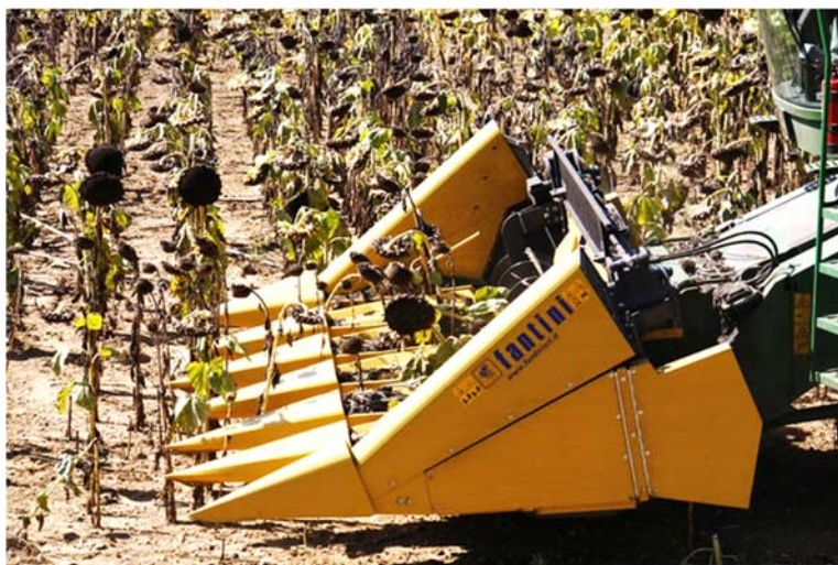
Вид сбоку количество рядов - от 4 до 12, расстояние - 45 см, 70см, 75см, 80см Рисунок 5. Жатка для уборки подсолнечника FANTINI G02 - GH2.
