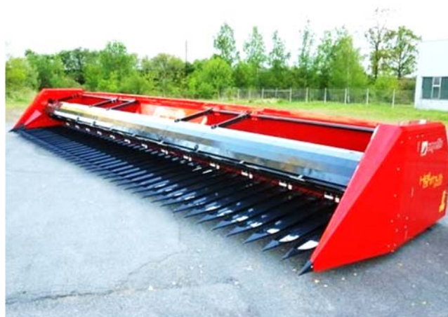
Рисунок 6. Жатка сплошного среза для уборки подсолнечника Capello Helianthus SF9400: фиксированная рама, привод режущего аппарата Schumacher, мотовило выставляемое по высоте, адаптер под комбайн
