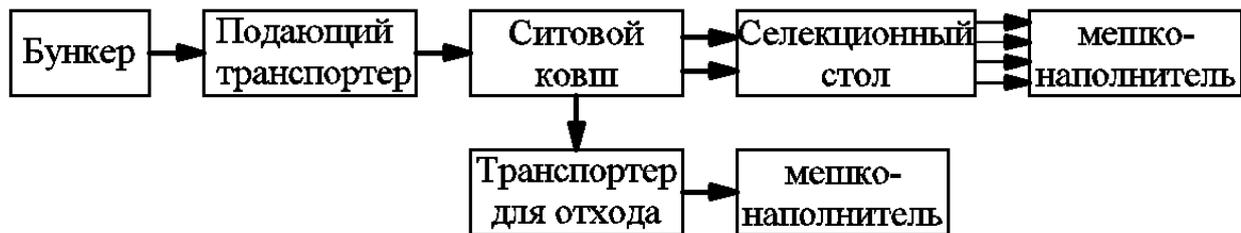
Рисунок – 2. Алгоритм работы картофелесортировочной машины «М-616»
