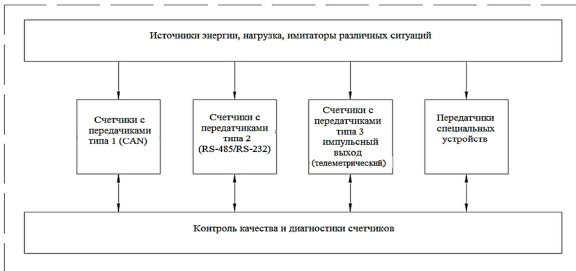
Рисунок 1 – Структурная схема поверочного стенда.
