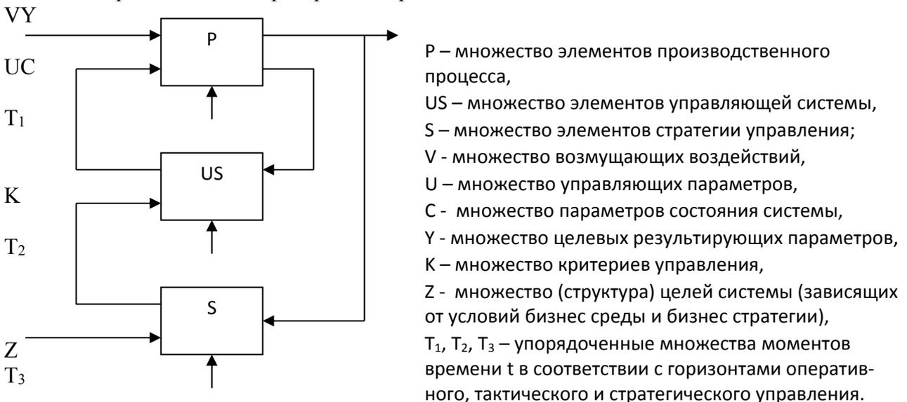
Рис. 1.4. Теоретико-множественное представление общей постановки задачи управления производством в зерноперерабатывающем предприятии
