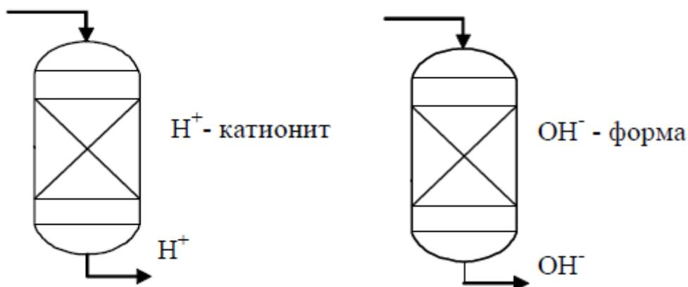
Рисунок 1- водород-катионитный и анионитный фильтр
