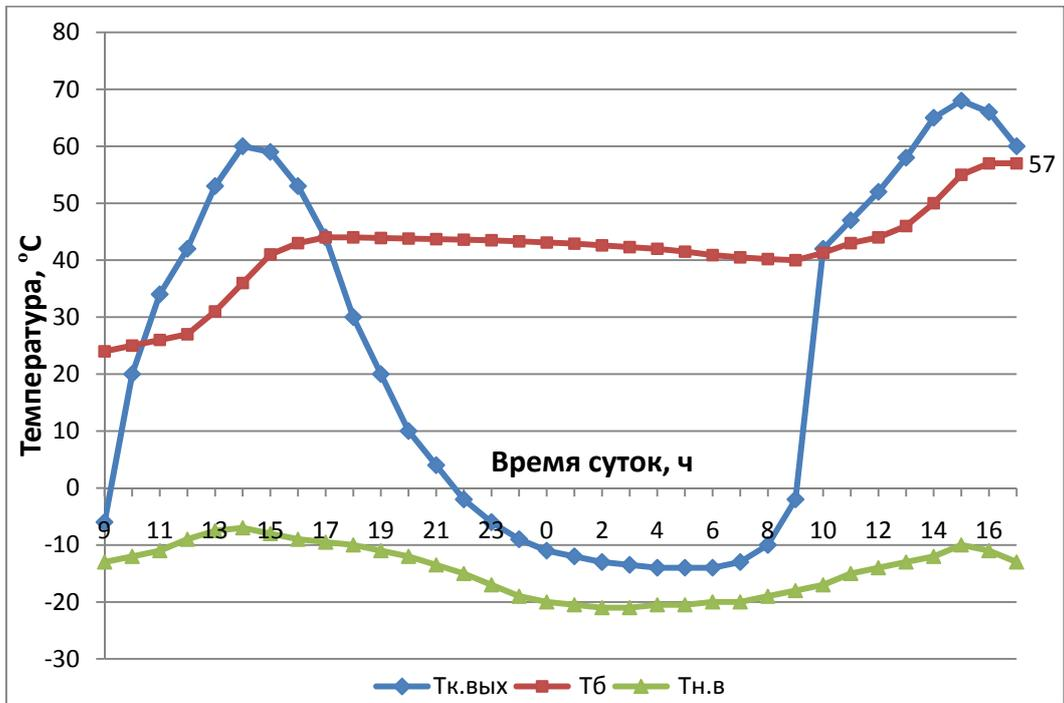
$T_{к.ВЫХ}$  – температура теплоносителя на выходе из гелиоколлектора;  $T_b$  – средняя температура воды в баке;  $T_{н.в}$  – температура наружного воздуха
