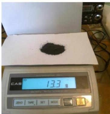
Рисунок 2 – Взвешивание шунгита на электронных весах
