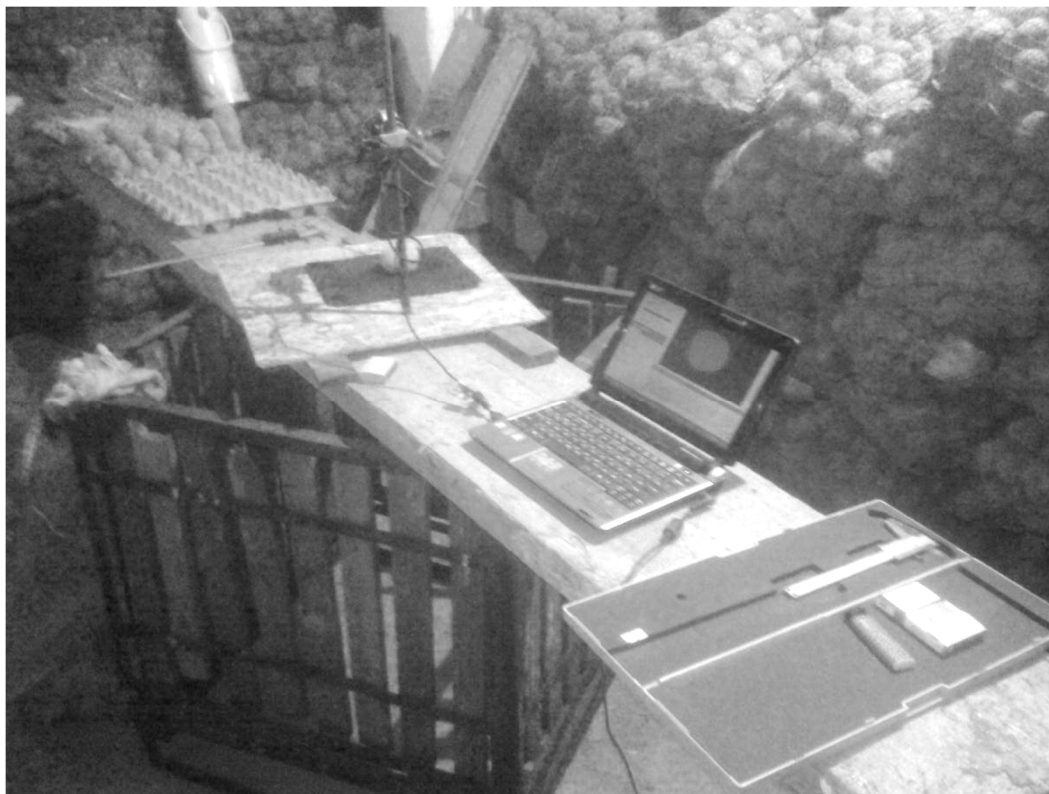
Рисунок 1 – Внешний вид рабочего места для исследования морфологических признаков клубней картофеля с помощью оптико-электронного устройства
