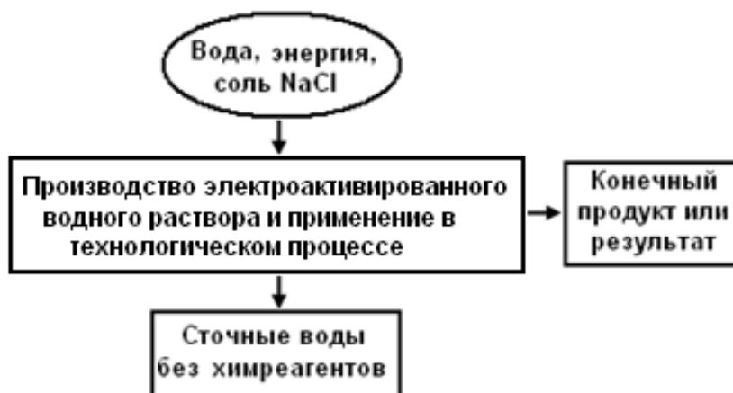
Рисунок 5 – Схема технологического процесса с использованием электроактивированного водного раствора NaCl
