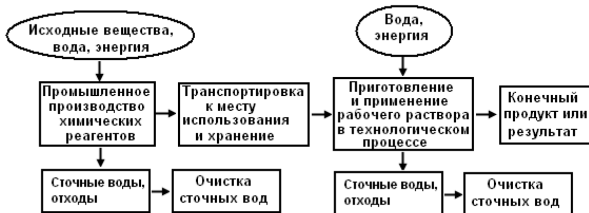
Рисунок 4 – Схема традиционной технологии с использованием покупных химических реагентов
