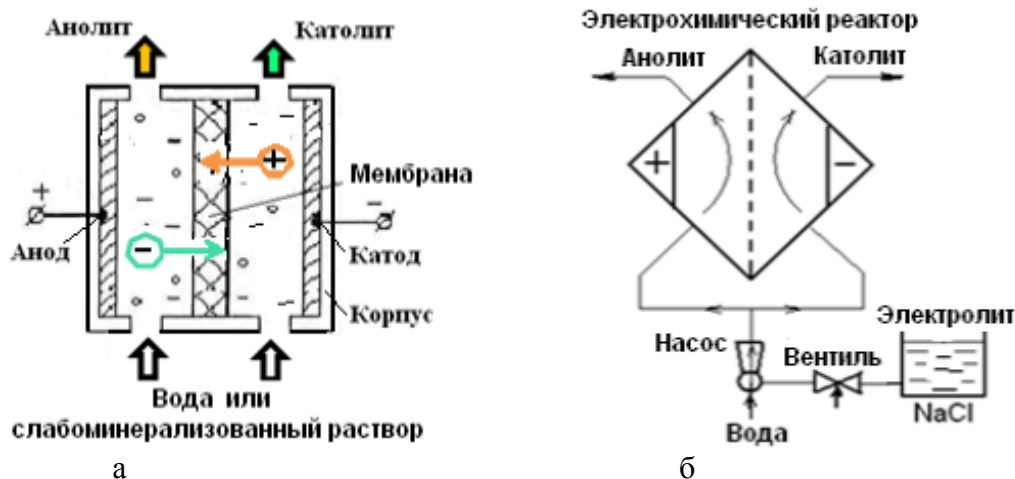
Рисунок 1 - Схема электрохимического реактора (а) и принципиальная гидравлическая схема (б) установки для получения анолита и католита
