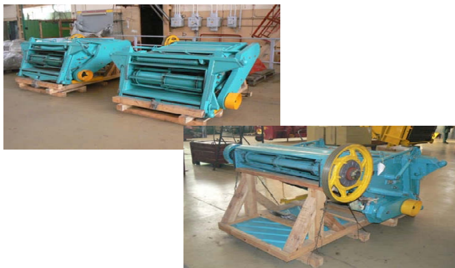
Рисунок 3. Заводские испытания опытных образцов наклонных камер в ОАО «Гомсельмаш»
