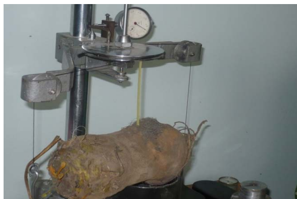
Рисунок 4. Прибор для определения усилий сдвига загрязнений.
