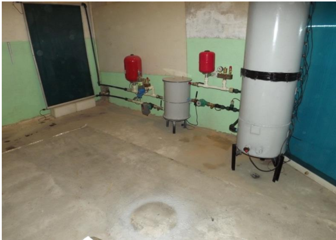
Рисунок 4 – Схема и общий вид стенда для исследования подсистемы «ТН-гелиоколлектор»
