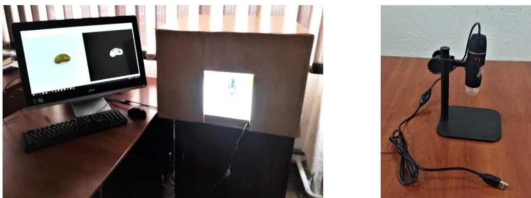
Рисунок 3 – Оптико-электронная система (а) и USB микроскоп (б) для распознавания объектов
