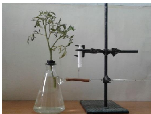
1 – облиственный побег; 2 – резиновая пробка; 3 – вода; 4 – коническая колба для вакуум-фильтрация; 5 – штатив; 6 – шприц с водой для выталкивания воздуха из правого конца капиллярной трубки; 7 – градуированная капиллярная трубка; 8 – воздух; 9 – резиновая трубка
