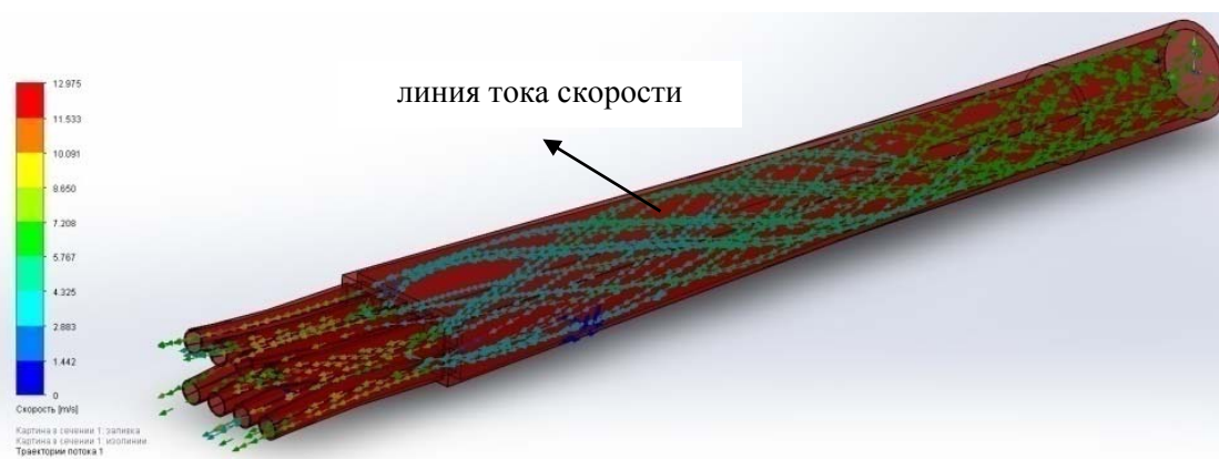
Рисунок 2 - Линии тока и поле скоростей воздуха в распределителе фирмы " Mogris "
