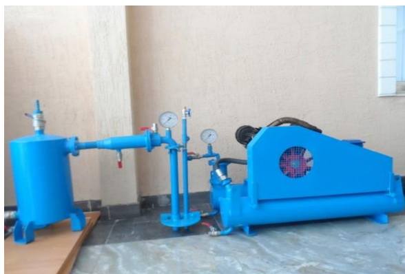
Рисунок 1 - Общий вид экспериментального образца пневмовакуумной (эрлифтной) насосной установки УНП-3,6-50
