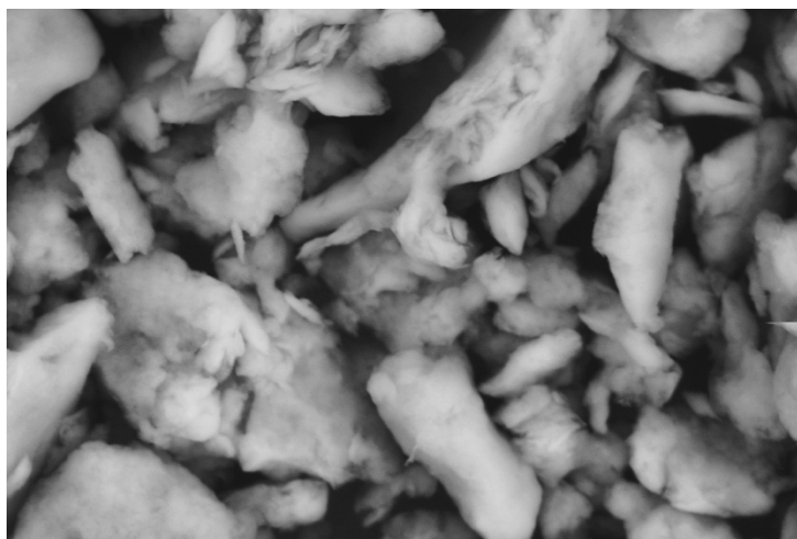
Рис. 1 – Структура бентонитовых глин Таганского месторождения ( \times 3000 ) В дальнейшем провели исследование содержания биологически активных веществ в полыни горькой и хвое пихты сибирской (таблица 2).
