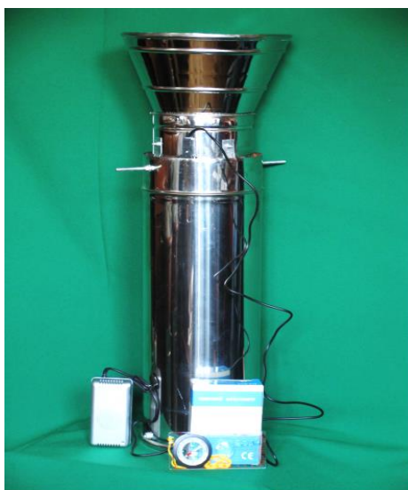
3-сурет – ЖЖ ЭМӨ қондырғының (тәждік разряд) жұмыс органының суреті: биіктігі – 700мм, қабылдау ұңғысының диаметрі – 300 мм, электромагниттік жүйесі бар цилиндр корпусының биіктігі – 500 мм, диаметрі – 180 мм.
