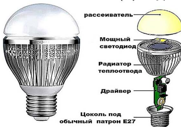
Рисунок 1 – Общая конструкция светодиодных ламп
