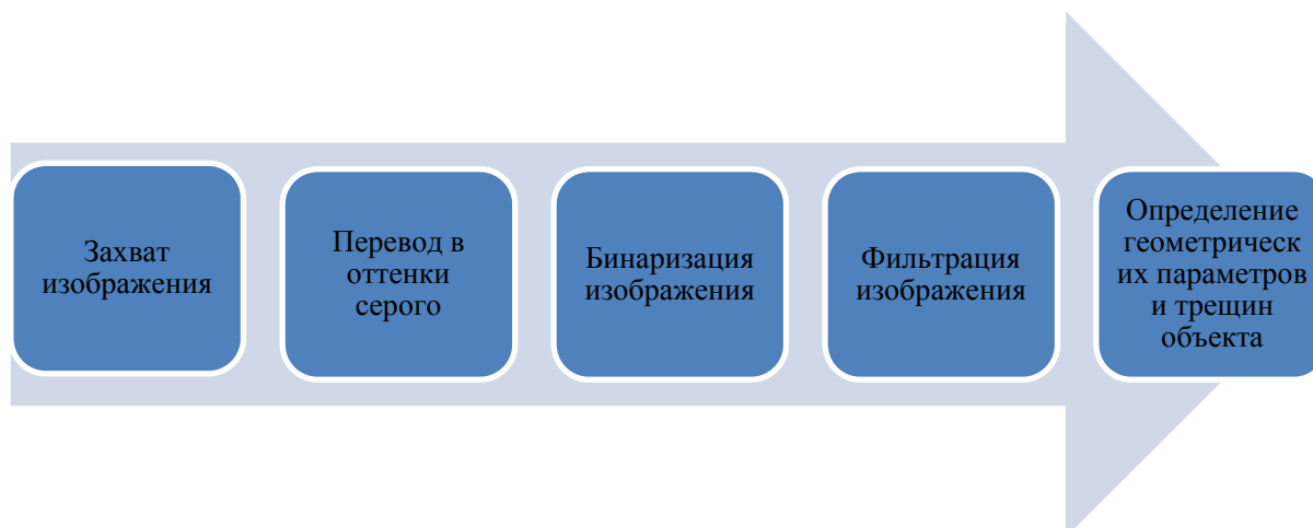
Рисунок 1 – Алгоритм работы программы обнаружения трещин
