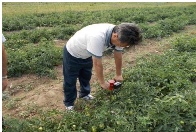
Рисунок. 4 Пенетрометр в состоянии проверки почвы
