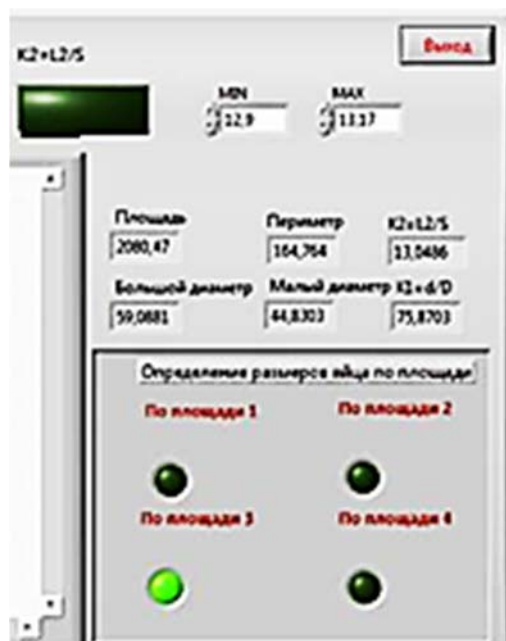
Рисунок 2 – Виртуальный прибор для визуального контроля параметров яиц
