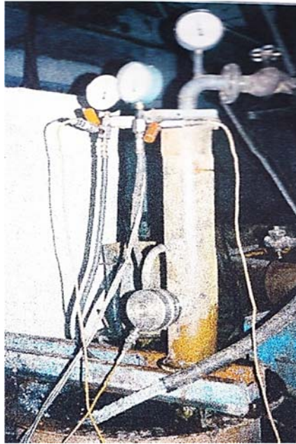
Рисунок 5 - Общий вид стенда по экспериментальному исследованию пакерных гидравлических устройств в комплекте с погружным электронасосом
