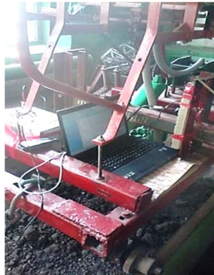
Рисунок 6– Общий вид лабораторной установки для оценки тягового сопротивления сошников
