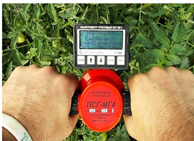
Рисунок . 3 Твердомер и электронный блок в работе
