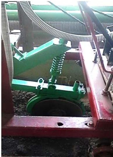
Рисунок 6– Общий вид лабораторной установки для оценки тягового сопротивления сошников
