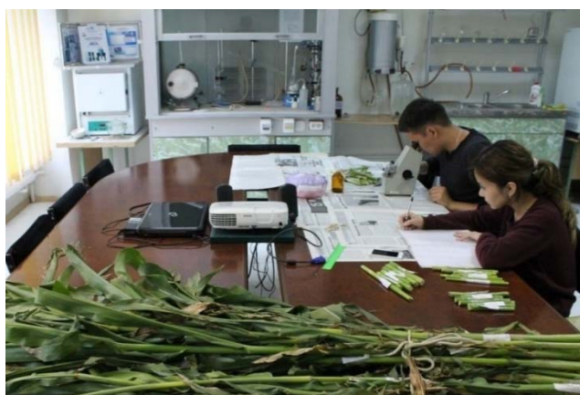
Рисунок 1 – Определение сахара в клеточном соке на рефрактометре ИРФ-454Б2М.
