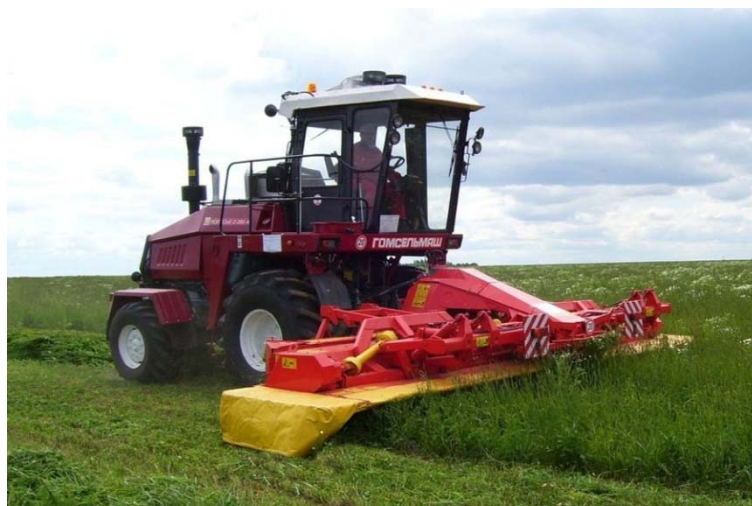
2-сурет. КПН-6-Ф тіркемелі- роторлы шөп шапқыш
