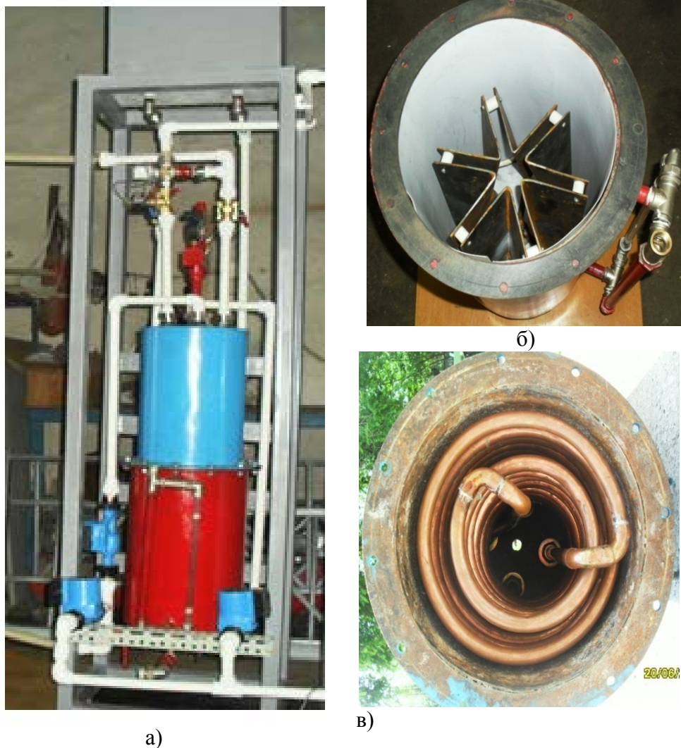
а) – общий вид пароводонагревателя; б) – общий вид электродной системы; в) – общий вид спиралевидных теплообменников.
