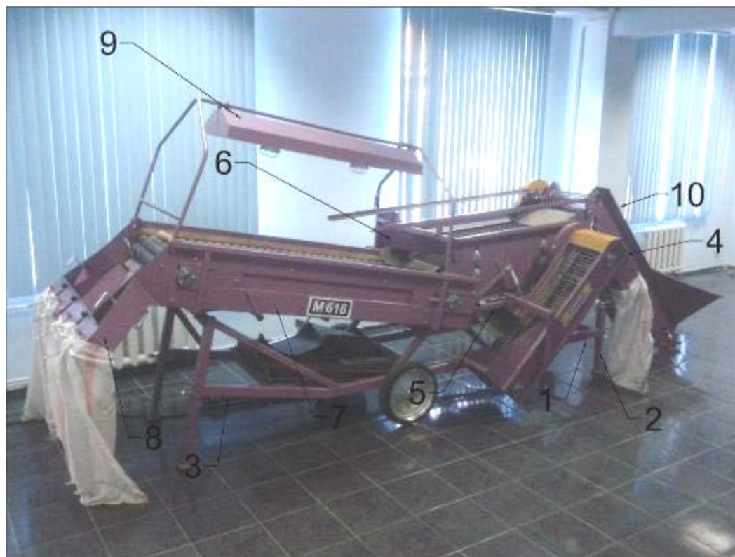
1–ходовая рама; 2 – передняя подпорка; 3 – задняя подпорка; 4– транспортер для отходов; 5 – подвижная рама; 6 –ситовый ковш; 7– секционный стол; 8 – мешконакопитель; 9 – кронштейн светильника; 10 – подающий транспортер Рисунок 1 – Внешний вид картофелесортировальной машины М-616
