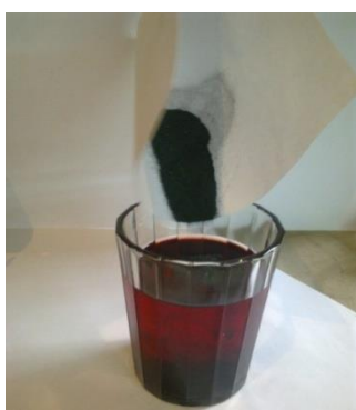
Рисунок 5 - Засыпка шунгита в трансмиссионное масло
