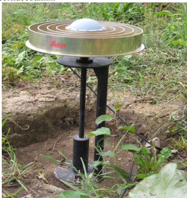
Рисунок 3 - Пункт измерения городской GPS-сети BAZA с помехо-защищенной антенной в рабочем положении
