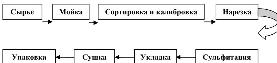
Рисунок 1 – Технологический процесс сушки яблок
